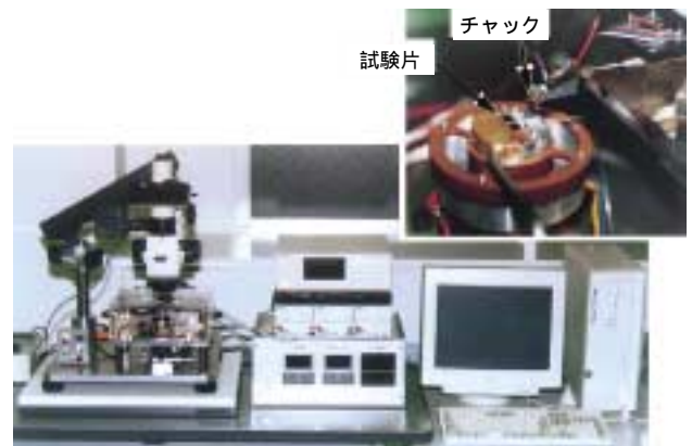
図2．静電チャック方式薄膜引張試験装置
