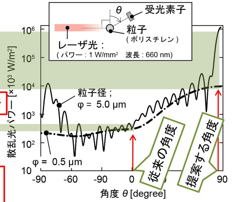
90度付近の散乱光を検出する光学系に変えることで、従来の約100倍の散乱光を検出可能
