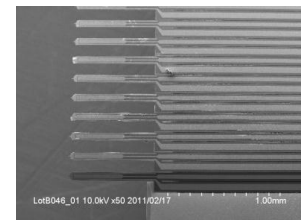
最先端8”ラインにて試作したマルチプローブアレイデバイス
