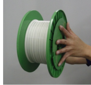
PEDOT被覆ナイロン線 (φ165μm)
