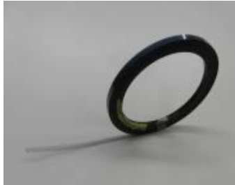
PEDOT被覆PET平線 (w:5mm × t:100μm)
