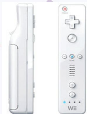
最新のゲーム機「Wii」や「プレイステーション2(PS2)」のコントローラは、MEMSの3軸加速度センサーなどを搭載し、コントローラを傾けるたり振ったりすることでゲーム・ソフトを操作できる。遊戯者の身振りによる、自然なインターフェースを提供している。
