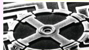
(2) 静電マイクロモータ (UCB '88) 直径120 \mu\text{m}
