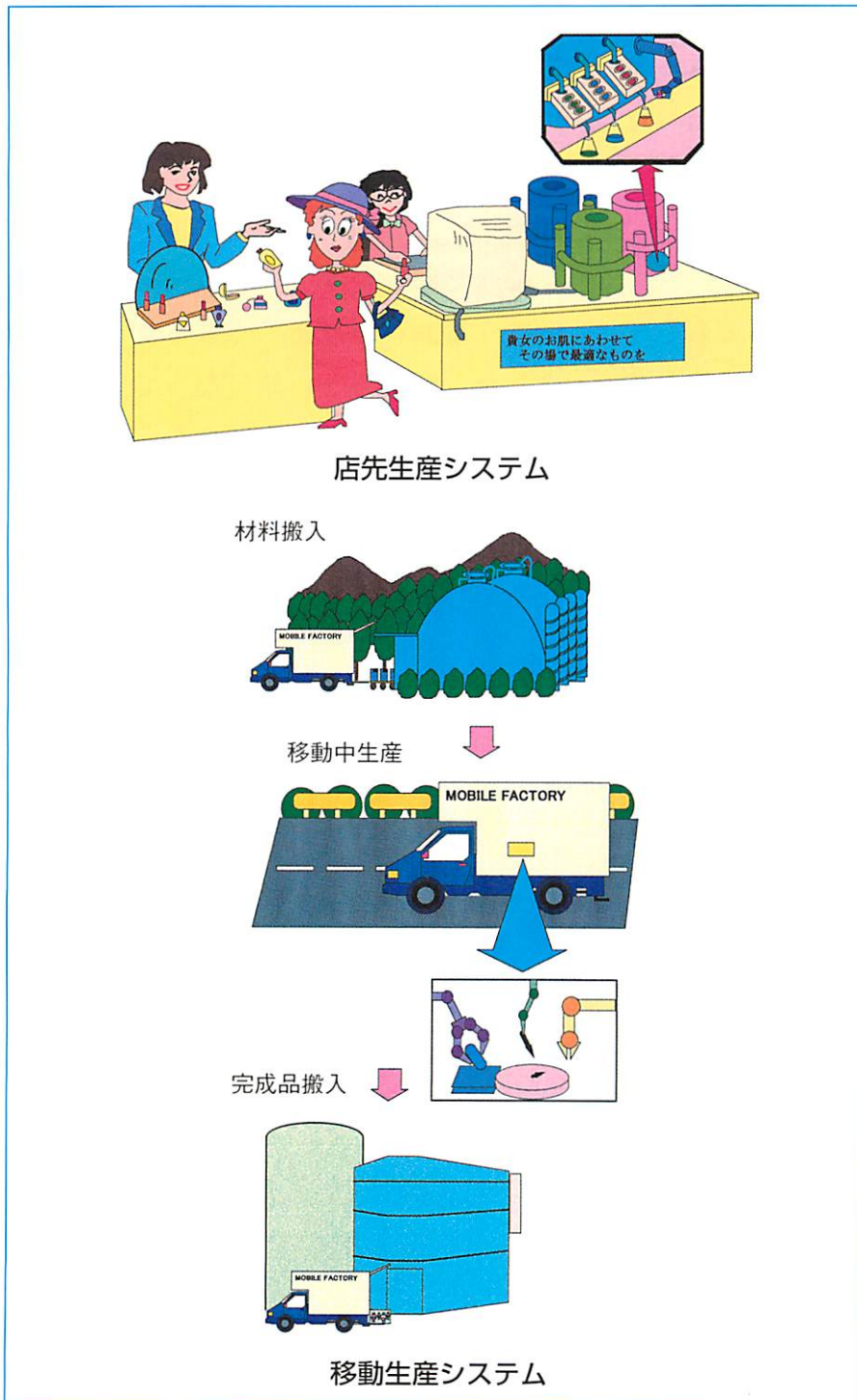
図 3-8 マイクロファクトリによる生産システム
