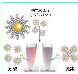
図2. ラクトースPEG化金ナノ粒子とレクチンとの混和
