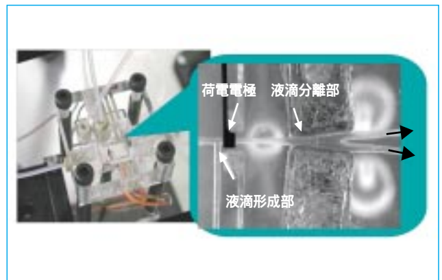
図1 マイクロソータの構成とソータ部写真
